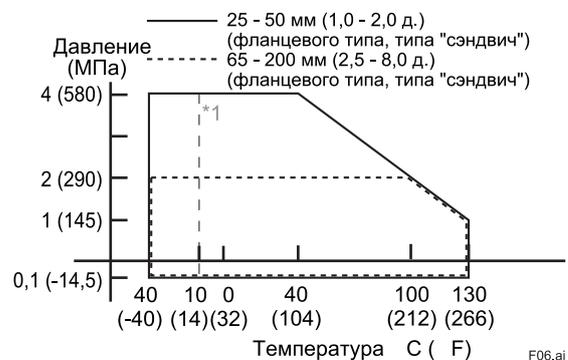
\*1: Для соединений типа «сэндвич» размером 40 - 200 мм (1,5 - 8,0 д.) минимальная температура рабочей среды: -10°C (+14°F).
